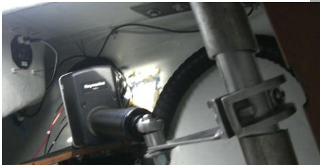
Mini cloison pour éviter l'inondation lors de la mise en place du loch
