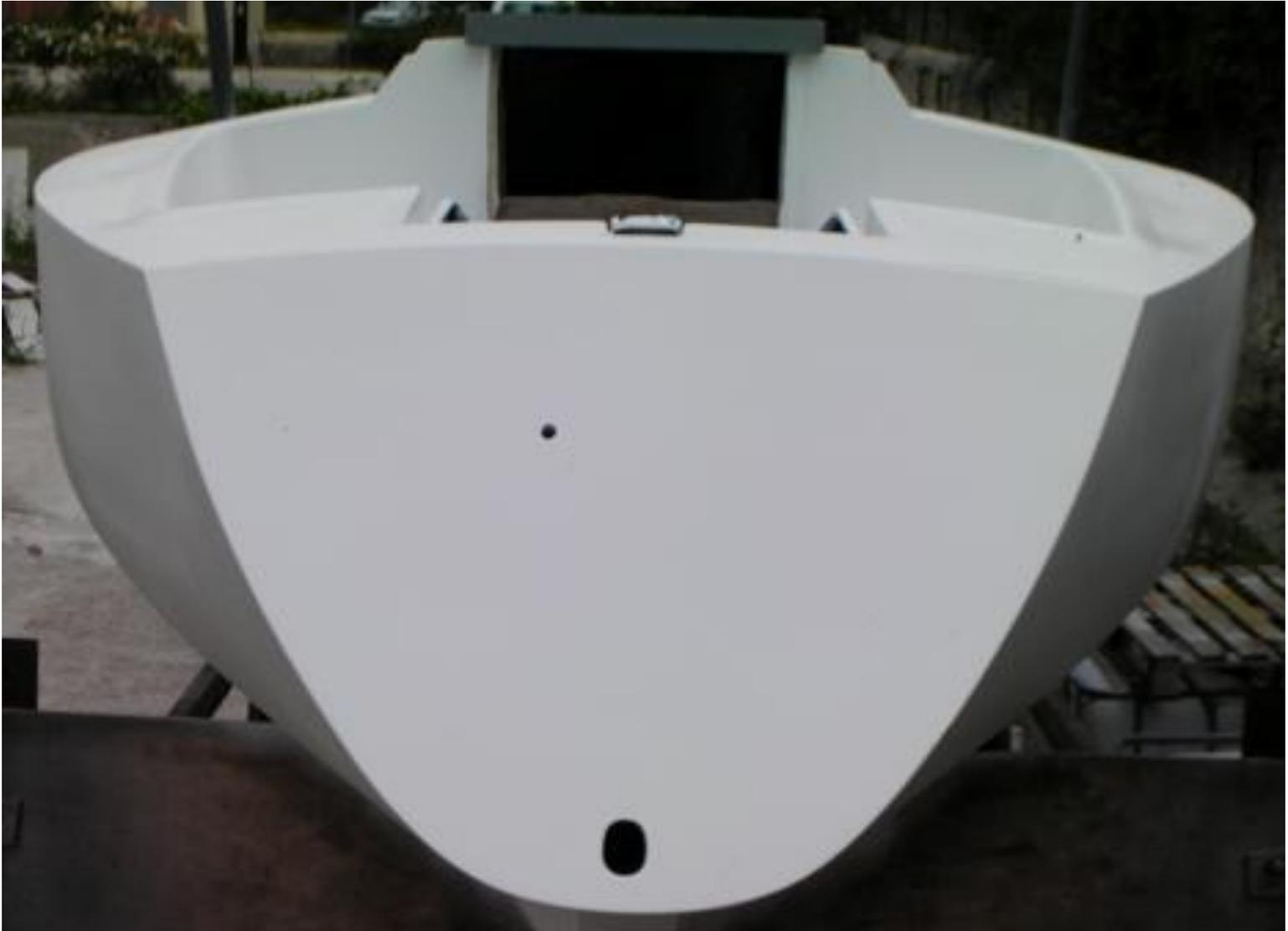
Réfection des rails de capot en contre-plaqué, collés et stratifiés époxy
