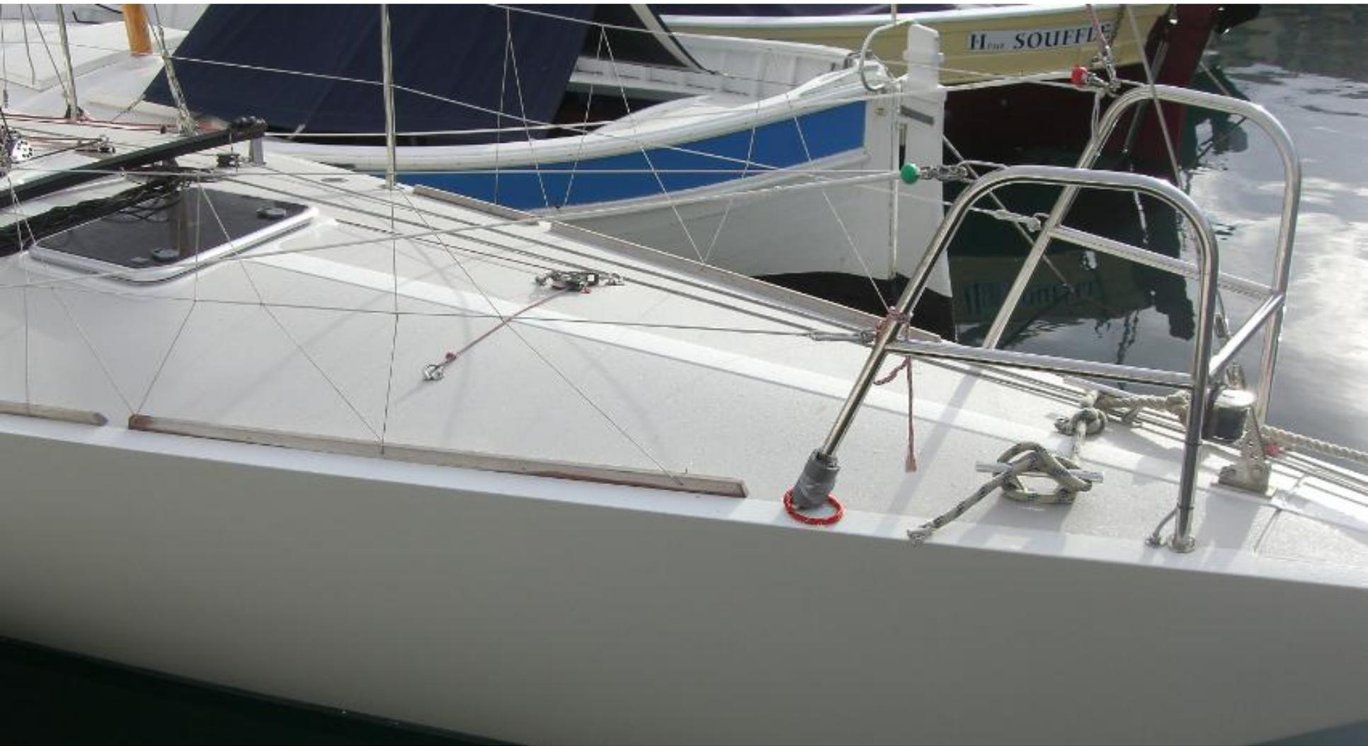
Balcon reculé pour mieux établir le code 0 (et reculer les poids)
